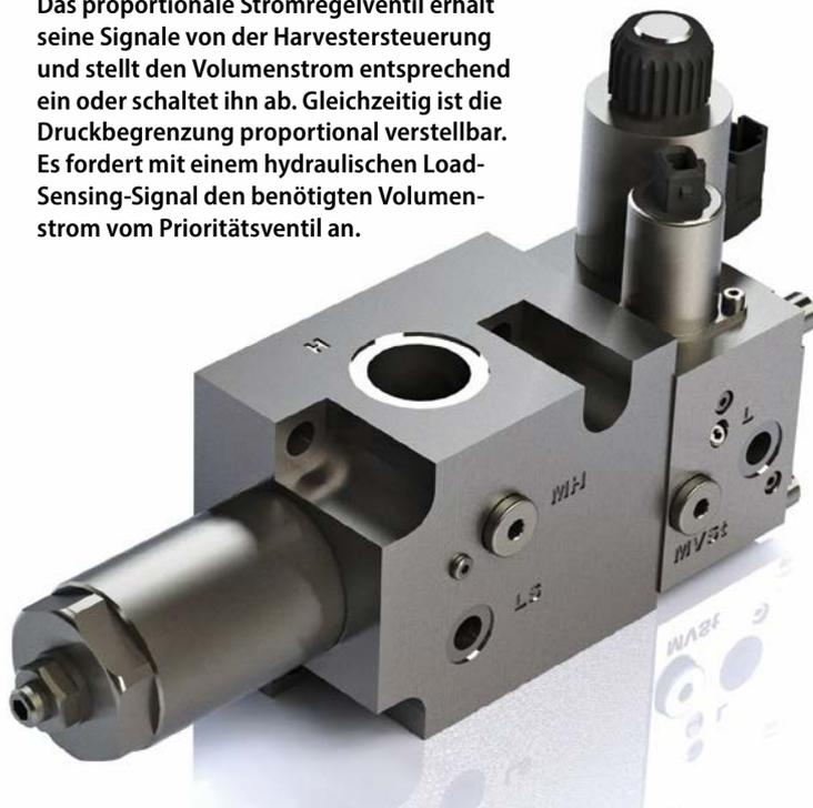
Das Prioritätsventil sitzt direkt am Pumpenausgang. Vom Stromregelventil gesteuert sperrt es den nachrangigen Volumenstrom variabel ab, so dass 0 bis 100 Prozent des gesamten Förderstroms zum vorrangigen Harvesterkopf geleitet werden können.
